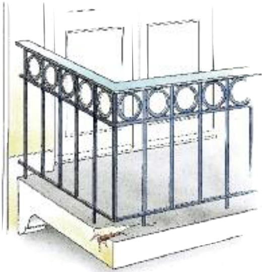
Skada orsakad av karbonatisering.
