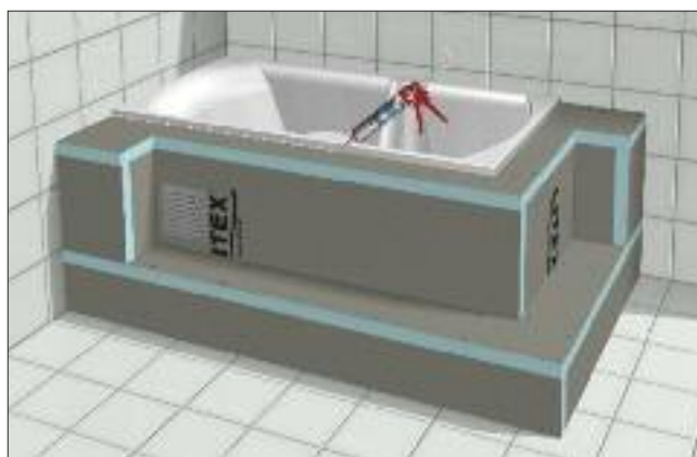
Använd Litex Våtrumsskiva som byggskiva till att t ex bygga in badkaret.
