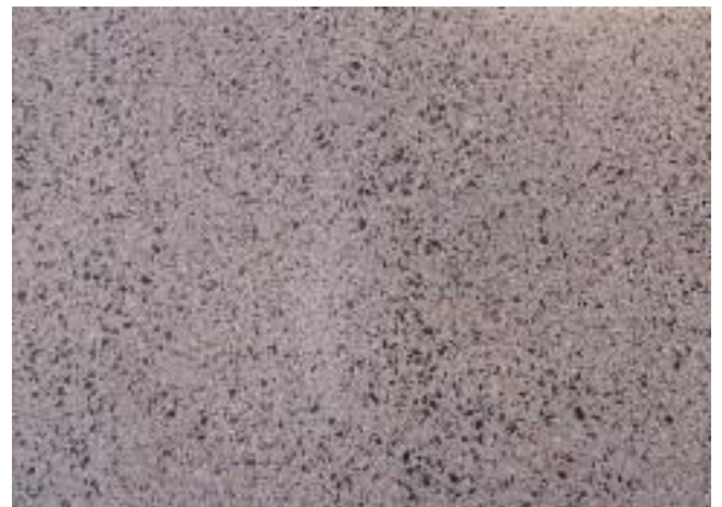
Floor 4635 DuroStone innehåller mörka hårdballastkorn med max kornstorlek 3 mm. Genom att slipa ytan kan man få dessa att framträda mot den ljusare bakgrunden.
